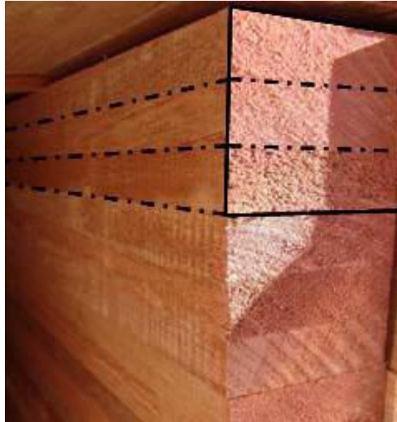
Εικόνα 2. Τρικολλητή ξυλεία Meranti διατομής 72x86 mm για παραγωγή κουφωμάτων διατομής 68x77 mm (I.V. 68 mm). Σκιαγραφείται η τριμερής σύνθεση του άνω τεμαχίου.
