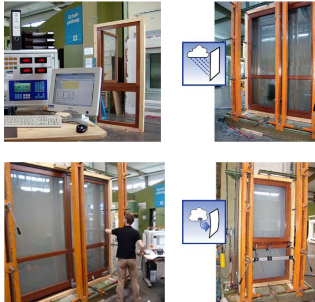
Εικόνα 5. Τεχνολογικές εγκαταστάσεις δομικών εργαστηριακών δοκιμών Αεροστεγανότητας/ανεμοπίεσης και υδατοστεγανότητας κουφωμάτων. Στην ίδια εγκατάσταση πραγματοποιούνται και οι εργαστηριακές δοκιμές ασφαλείας (έκθεση σε ακραίες συνθήκες τυφώνα).
